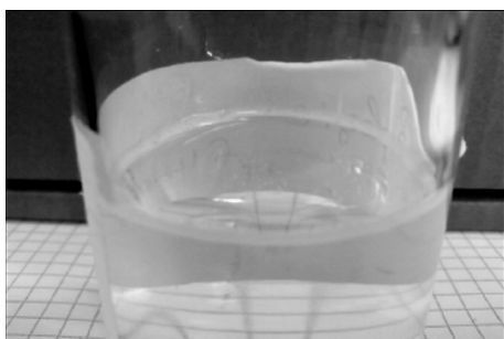
Skumbildsfilter ok: mycket tunn skumring runt kanten, vilken löses upp snabbt.
