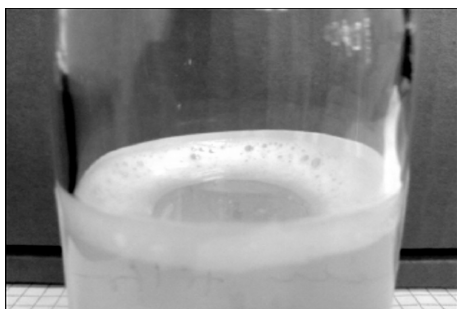
Filtri vahupilt ammendunud: servas paks vahurõngas, mis ei lagune.
